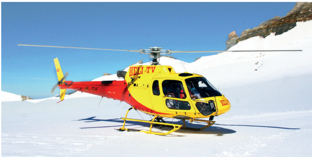
Typische Heliskiing-Helikopter wie dieser H125 Ecureuil, hier auf dem GLP Jungfrauoch, verbrauchen pro Stunde rund 150 Liter Treibstoff. / Les hélicoptères typiquement utilisés pour l'héiski, avec ici l'Écureuil H125 sur la PAM du Jungfrauoch, consomment environ 150 litres de carburant à l'heure. Photo Heli TV
