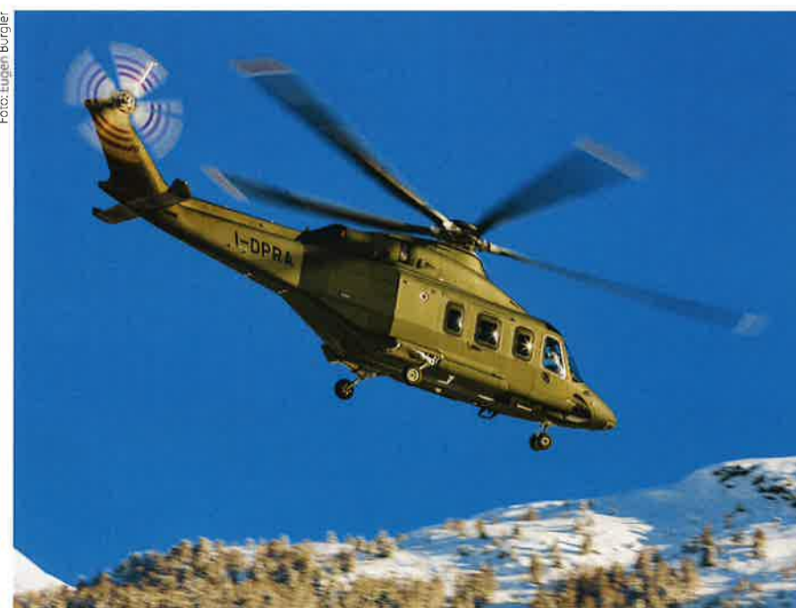
Bei modernen Helikoptern wie diesem AW139 kompensieren SAS-Systeme (Stability Augmentation System) Asymmetrien beim Abflug.
