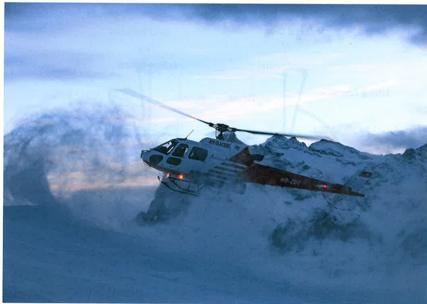
Der Downwash eines Helikopters zeigt eindrücklich, wie grosse Luftmassen vom Rotor vertikal beschleunigt werden, was im Winter besonders gut zum Ausdruck kommt.
