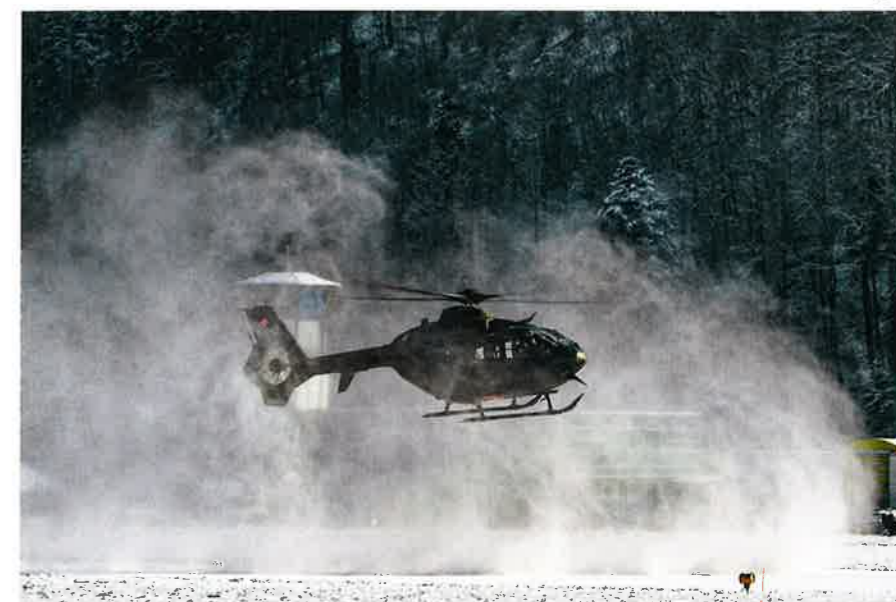
Le Downwash d'un hélicoptère montre de manière impressionnante l'ampleur des masses d'air accélérées verticalement par le rotor, ce qui s'exprime particulièrement bien en hiver.
